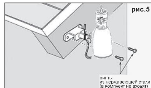
После закрепления отрегулируйте датчик дождя в вертикальном положении.
