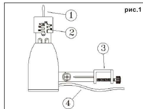
1. Проверочный штырь – нажмите для проверки работы датчика дождя вручную.
