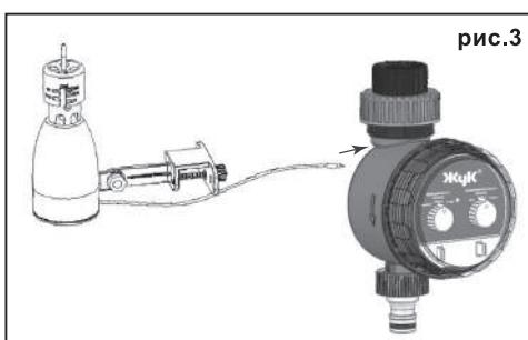
Вставьте штекер датчика дождя в разъём таймера полива.
